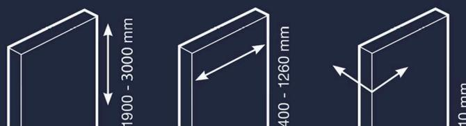
**Dimensioni su misura.** Le ante sono personalizzabili in larghezza fino a un massimo di 1260 mm, in altezza fino a un massimo di 3000 mm. Spessore vetro 10 mm (monolitico temperato o stratificato temperato).
